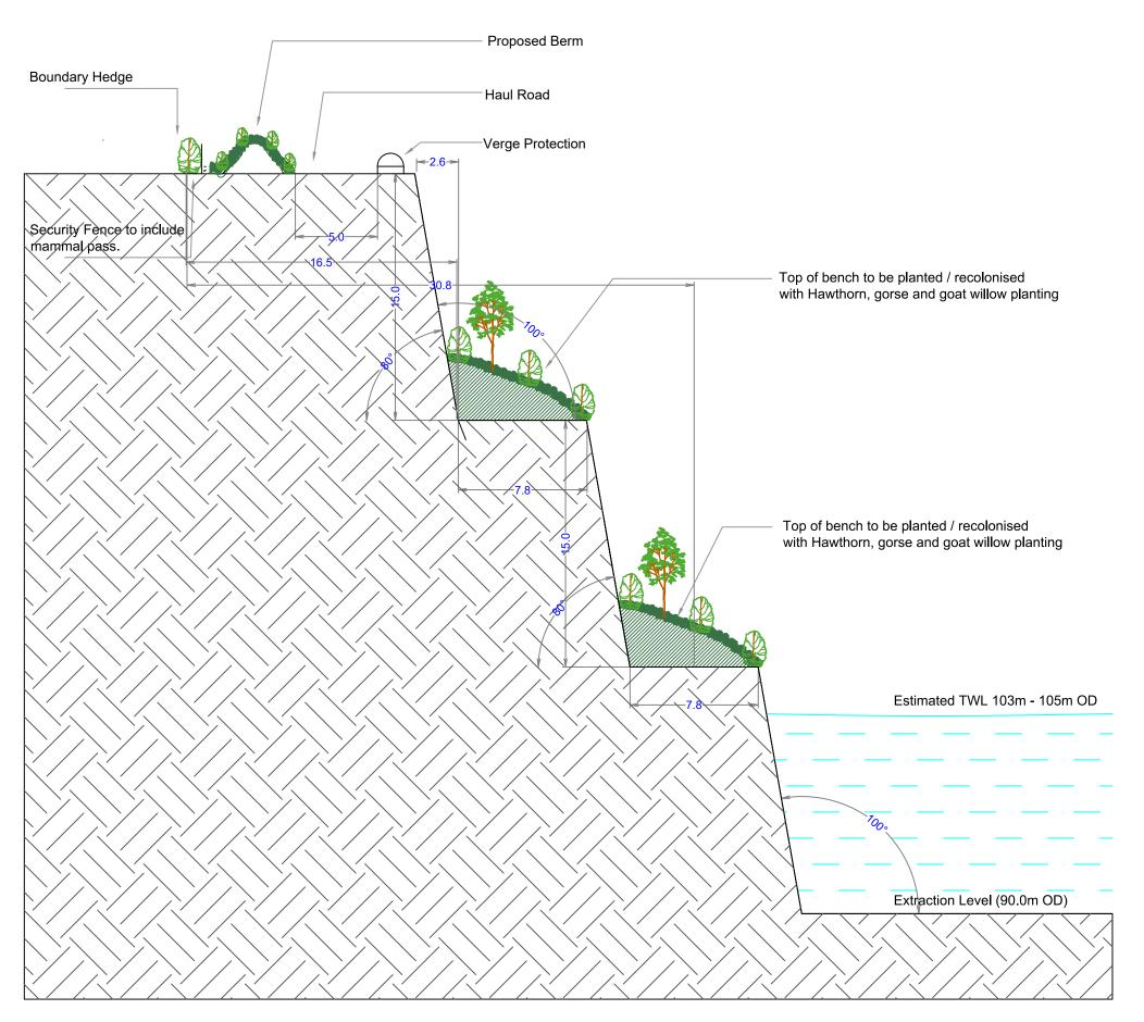
TYPICAL SIDE SLOPE DETAIL
